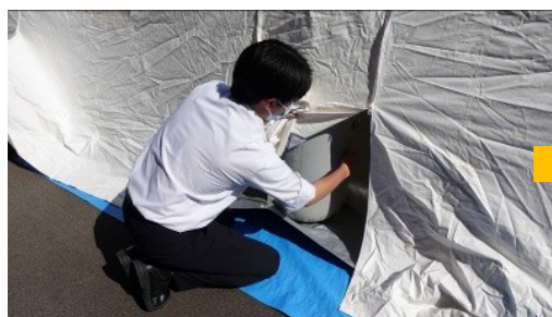
①中央のバルブからゆっくりと開放し空気を抜いていく。
